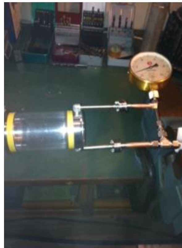
耐圧テストの様子 (差圧:4 atm)
