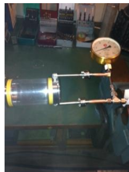
耐圧テストの様子 (差圧:4 atm)
